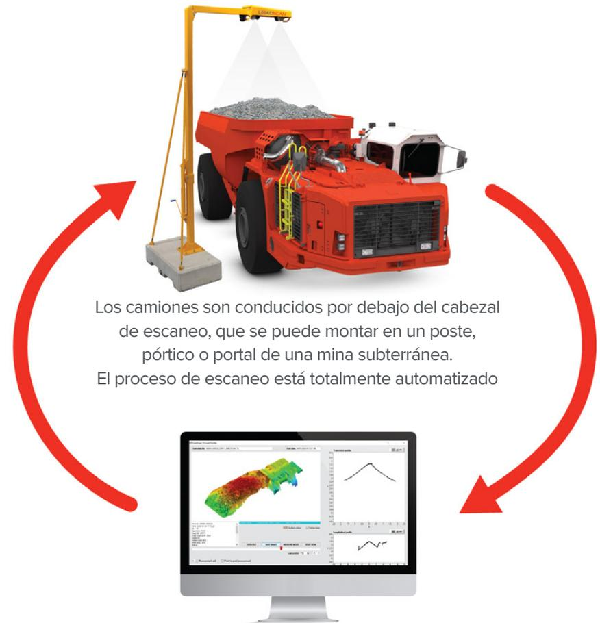
El software de minería patentado Loadscan informa la medición volumétrica, incluidos los perfiles de carga 3D de cada carga
