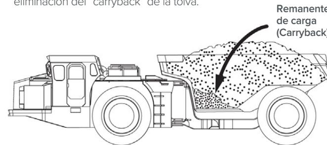
Los paneles de mensajes LED indican la cantidad de material remanente en la tolva “carryback”. Una vez que se excede el umbral establecido, el conductor puede raspar el contenedor para eliminar el “carryback” de la tolva.
